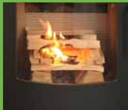
Die Flammen arbeiten sich langsam von oben nach unten. Nach ca. 45-60 Min. sind die letzten Flammen ausgegangen und es hat sich eine schöne Glutschicht gebildet. Neues Brennholz wird normalerweise nachgelegt, solange sich noch Glut im Ofen befindet. Verteilen Sie mit dem Feuerhaken die Glut auf dem Boden der Brennkammer - am meisten vorne im Ofen.
